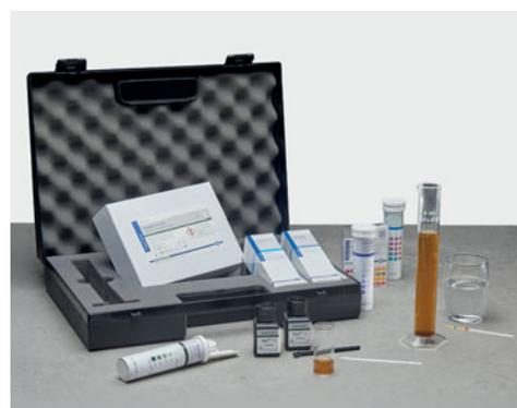
Effectuez des tests et mesurez les paramètres directement sur chantier ou en envoyant les échantillons dans un laboratoire spécialisé. La mesure de la turbidité est également obligatoire lors de la maintenance d'une chaudière et d'une pompe à chaleur : arrêté du 24 juillet 2020.
